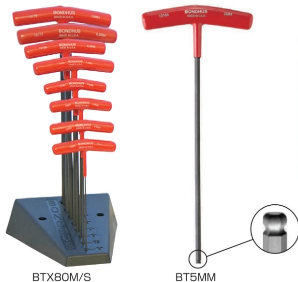
T-ハンドルはトルクが過剰になりやすい形状をしています。小さなボールポイントでは簡単に破損してしまう為、2、2.5、3mm、3/32、7/64、1/8、9/64インチは通常の六角になっています。
